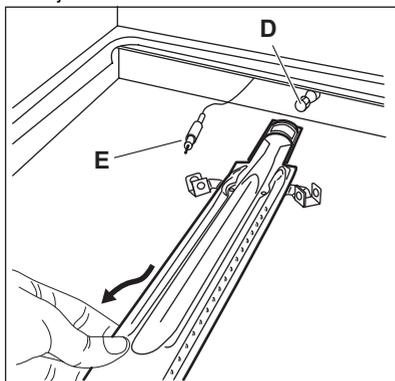
4. Déplacez-le ensuite lentement vers la gauche. Assurez-vous que la bague du brûleur reste sur l'embout de ce dernier. Ne forcez pas sur le fil du conducteur du thermocouple E.
